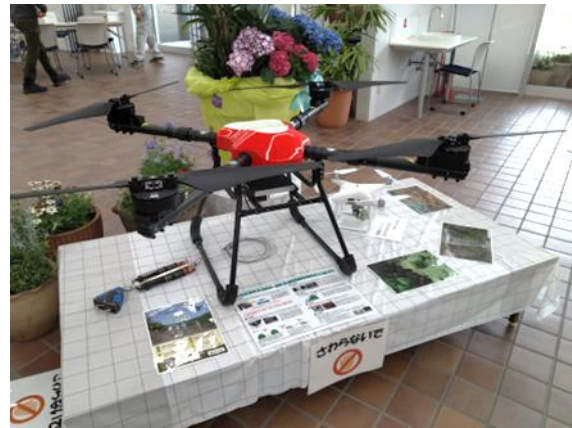
図 2. ドローン。大きくて赤いものは 15 kg までの資材（苗など）の運搬が可 能、小さくて白いものは空中撮影を 行う。
